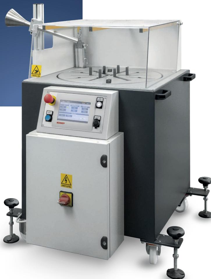
Questa macchina è stata progettata per riavvolgere in matasse cavi e tubi flessibili. Per facilitare il posizionamento è stata montata su ruote girevoli autobloccanti. Può essere collegata in linea con macchine taglia-spela o spezzatrici SAMEC, e con l'ausilio di un encoder e di un sensore esterno può lavorare anche con macchine non SAMEC.
